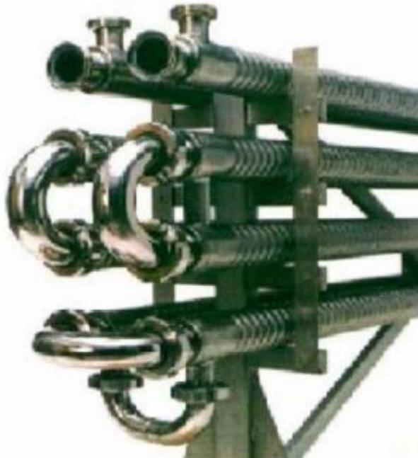
*Nota.* Sistemas de tuberías con el fin de prolongar y de mantener la temperatura adecuada durante el proceso de pasteurización. Obtenido de J. Bonilla y E. Cordero (2010). *Diseño y análisis de un sistema de instrumentación y automatización industrial aplicado al proceso de pasteurización de una planta de elaboración de cerveza.* [Tesis de pregrado, Escuela Superior Politécnica del Litoral]. Repositorio institucional.
