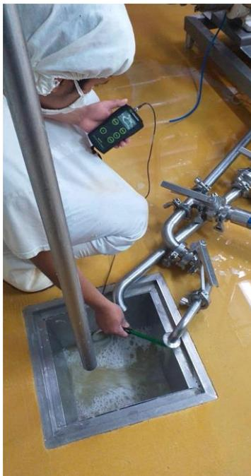
*Nota.* Tras la limpieza, esta separación eficiente permite aislar las soluciones de soda usadas para su tratamiento y reciclaje adecuado. Elaboración propia.
