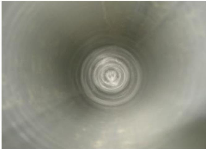
*Nota.* El diseño del sistema de distribución debe minimizar el número de soldaduras, codos y uniones tipo abrazadera. Obtenido de Ascend Media (2011). Mejorando la limpieza sustentable. *Industria Alimenticia*, 22, p. 37.
