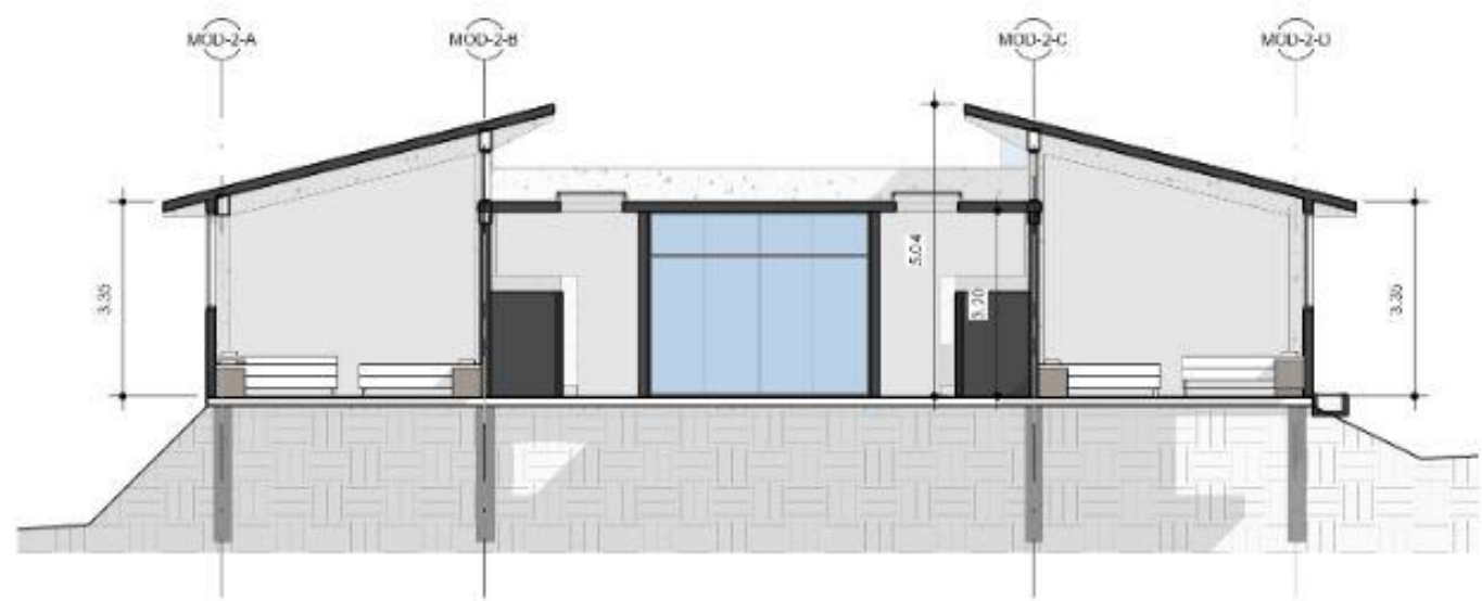
2 SECCIÓN TRANSVERSAL ÁREA DE SERVICIOS 1:100
