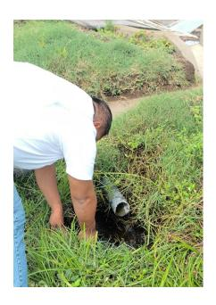
Nota. Recoleccion de la muestra de agua al final de las tuberías. Elaboración propia.
