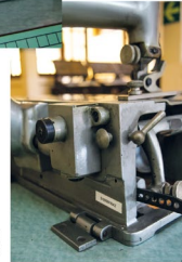
Manera en la que está fijada la máquina a la mesa.
