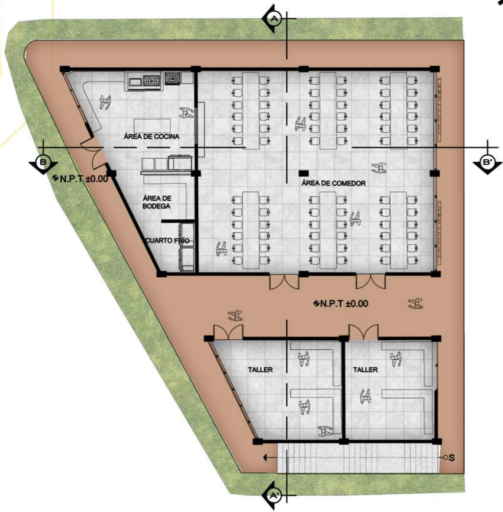
PLANTA ARQUITECTÓNICA COMEDOR / TALLERES PRIMER NIVEL
