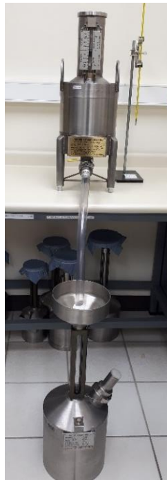
Figura 6. Sistema armado para transferencia de volumen
