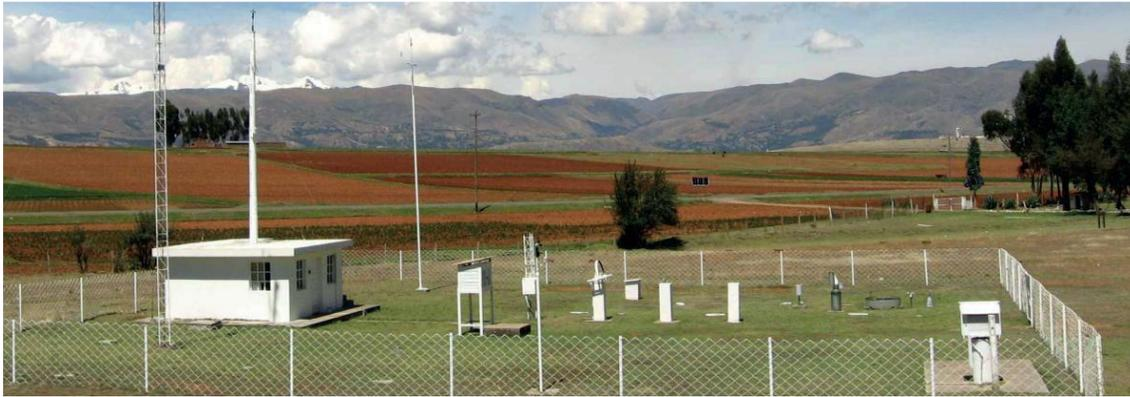
*Nota.* Detalle de una estación meteorológica de superficie, la cual registra datos de precipitación, temperatura, radiación solar, entre otras. Obtenido de USAID (2015). *Manual de meteorología y gestión de la información climática.* ([https://pdf.usaid.gov/pdf\\_docs/PA00N1N1.pdf](https://pdf.usaid.gov/pdf_docs/PA00N1N1.pdf)), consultado el 10 de abril de 2022.
