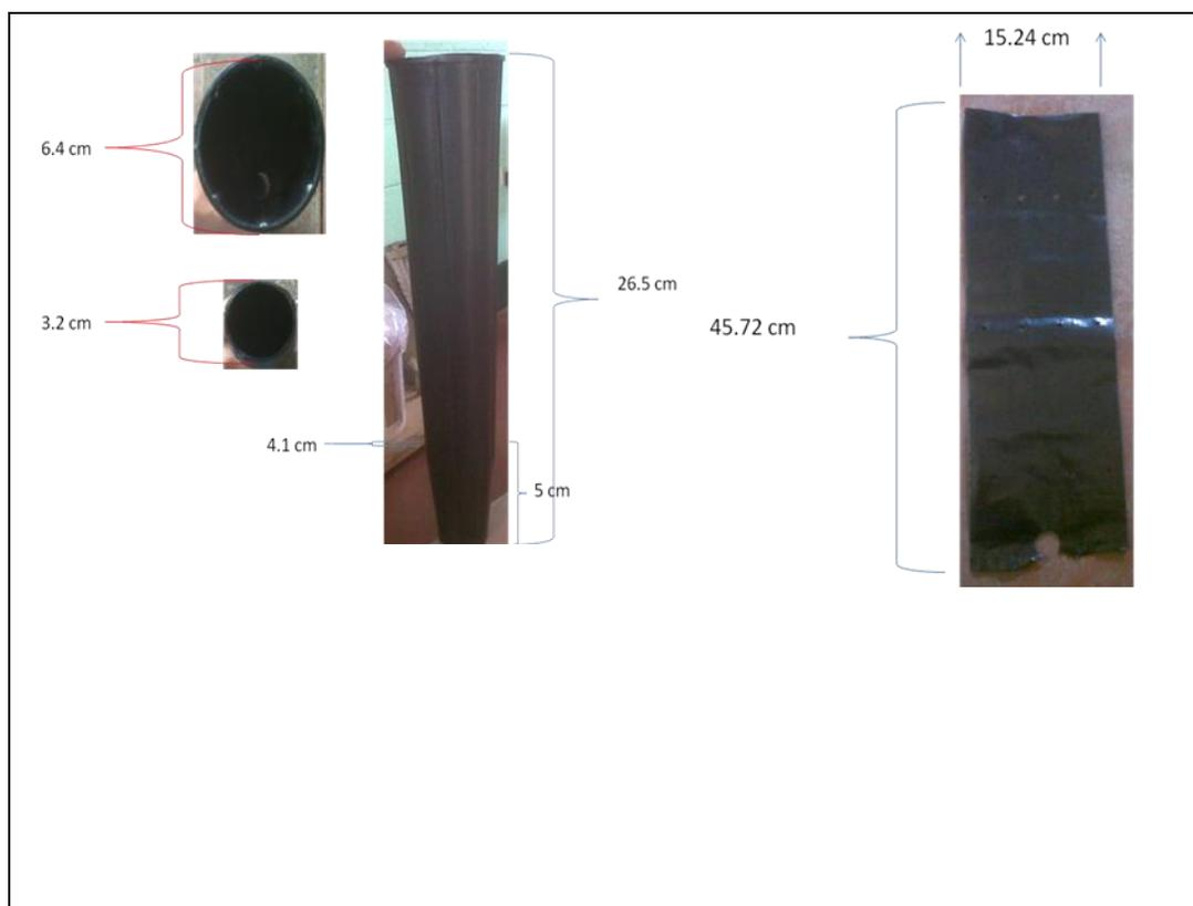
**Figura 8. Tubetes de polipropileno y bolsas de polietileno utilizando en la investigación con sus dimensiones.**
