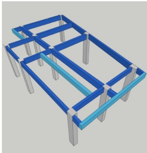
Figura 136. (Izquierda) Detalle de un nivel para mostrar la jerarquía de vigas del sistema estructural, de esta manera se reinterpreta también sistema de madera. En azul se muestran las vigas primarias, en celeste las secundarias y en gris las columnas.
