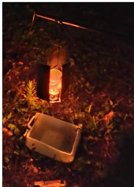
**Figura 36:** Trampa de Luz Amarilla de keroseno (T3).
