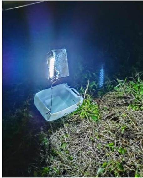
**Figura 12:** Trampa LED, instalada.
