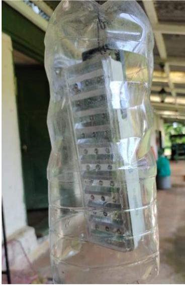
**Figura 11:** Lámpara LED, con protección plástica.
