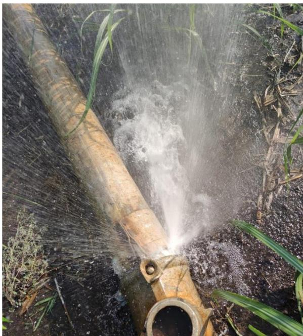
**Figura 16: Fuga por mala instalación en finca Minar sección 2.**
