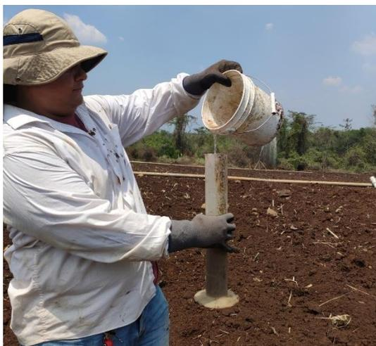
**Figura 11: Medición de aplicación de agua de riego.**
