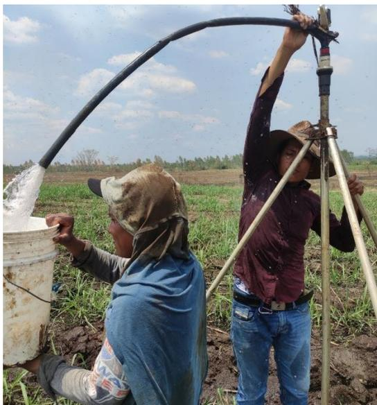
**Figura 9: Realización de aforo en sistema de riego de baja presión.**
