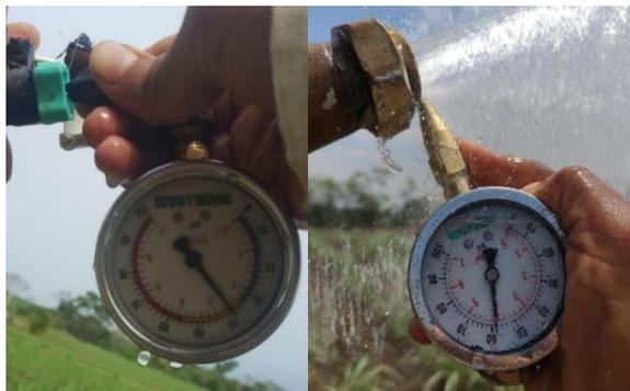
**Figura 3: Medición de presión de salida de caudal de aspersores de ambos sistemas evaluados.**
