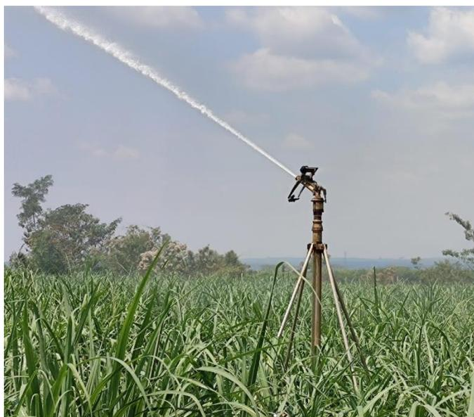
**Figura 2: Sistema de riego de alta presión instalado en Finca Tululá sección 2.**
