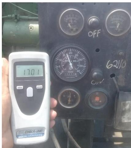
**Figura 4: Monitoreo de RPM del motor.**
