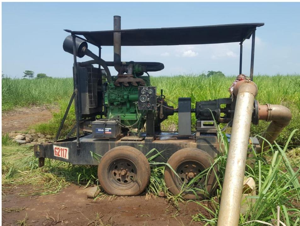
**Figura 20: Motobombas John Deere serie 6068TF150 de 150 HP 1800 rpm, utilizados en Ingenio Tuluá para aplicación de riego en caña de azúcar.**
