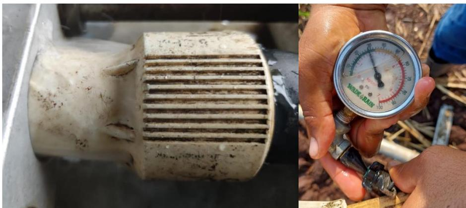
**Figura 18: A) Fuga de agua en regulador de presión de sistema de riego de baja presión. B) Presión de salida de aspersor a 30 PSI.**
