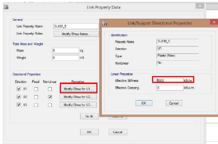
Fuente: Bozzo, L., Gaxiola, G. y Gonzales H. (2021). *Proceso de análisis y diseño utilizando disipadores sísmicos tipo SLB*. pág. 26.
