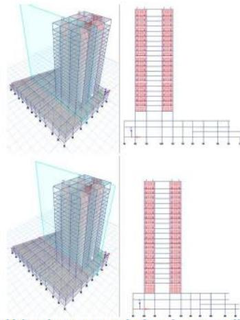
*Modelo ETABS de edificio Urbania mostrando los 4 muros discontinuos necesarios para reducir el desplazamiento de entrepiso, todos en la dirección Y.*
