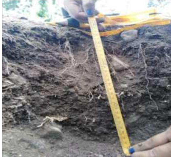
**Figura 5.** Toma de muestras de suelo para análisis de laboratorio y para los tratamientos.
