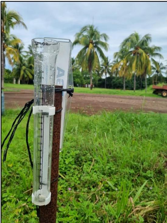
Figura 34. Pluviómetros utilizados en las distintas localidades.
