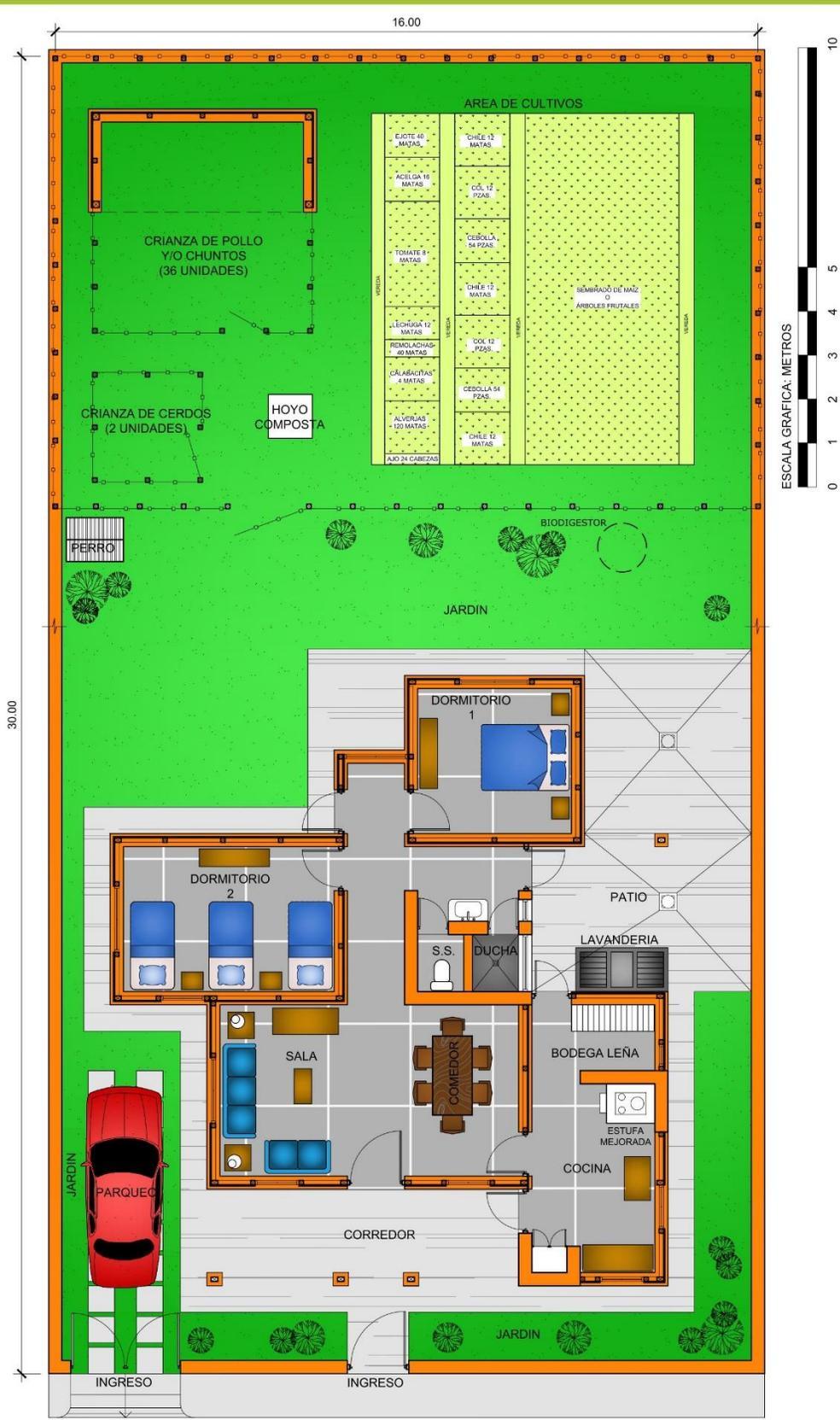
PLANTA ARQUITECTÓNICA -FASE 2 DE LA VIVIENDA 134.60 M2 CONSTRUCCIÓN HABITABLE-
