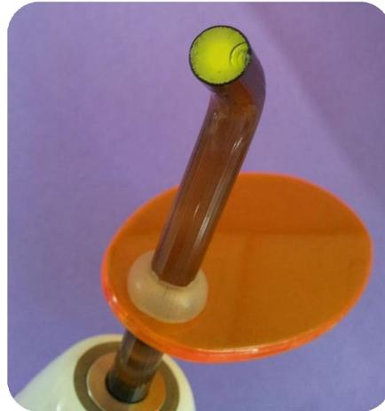
**Fotografía 4.** Medición de la intensidad de lámpara LED con fibra óptica fracturada marca ART. En la imagen A se observa la fractura en el borde de la fibra óptica y en la imagen B se utilizó un radiómetro para medir la intensidad que dió resultado de  $200\text{mW}/\text{cm}^2$ .
