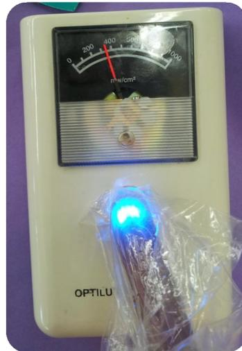
**Fotografía 6.** Medición de la intensidad de una lámpara halógena sin barrera protectora de plástico transparente. Se registró un resultado de  $380 \text{ mW/cm}^2$ .
