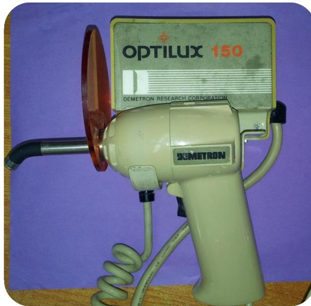
**Fotografía 20.** Lámpara halógena marca Demetron registró una intensidad de  $180\text{mW}/\text{cm}^2$ , intensidad deficiente para polimerizar una resina compuesta.
