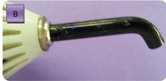
**Fotografía 3.** Fibra óptica fracturada.
