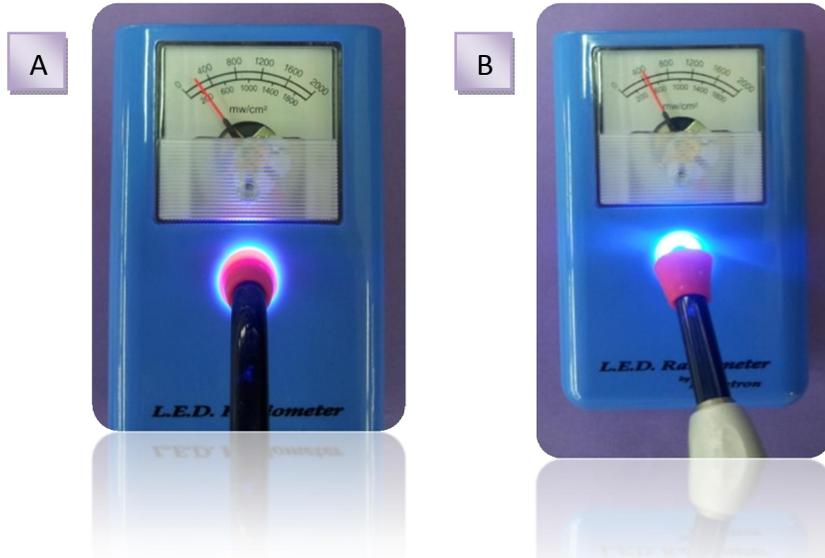
**Fotografías 9 y 10.** Comparación entre las imágenes A y B donde se realizó la medición de la intensidad de una lámpara LED marca Spring Health Products con y sin aditamento de goma, respectivamente. En la imagen A se registró una intensidad con aditamento de  $100 \text{ mW/cm}^2$  y en la imagen B sin aditamento aumentó a  $800 \text{ mW/cm}^2$ .
