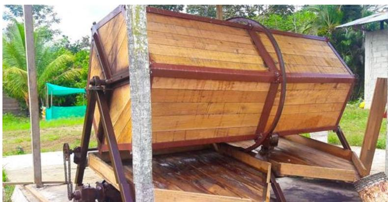
**Figura 16. Fermentador tipo barril rotatorio hexagonal.**
