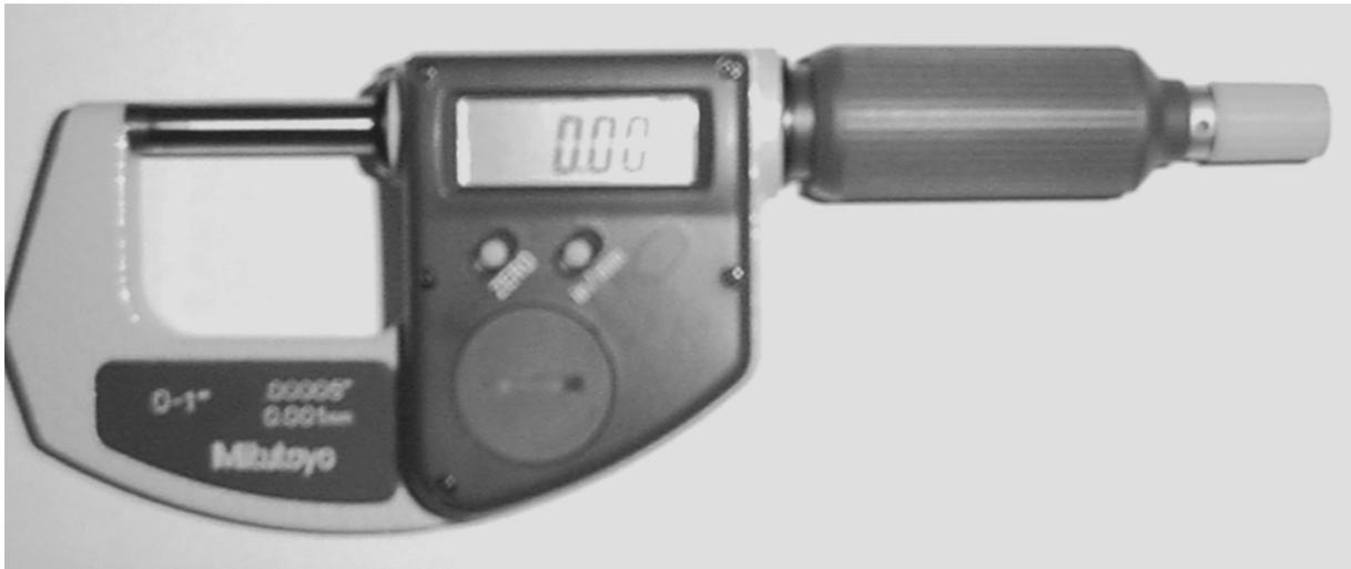
**Presenta la medición en milímetros o en pulgadas y tiene una capacidad de 0.001 de mm ó 0.00005 de pulgada.**
