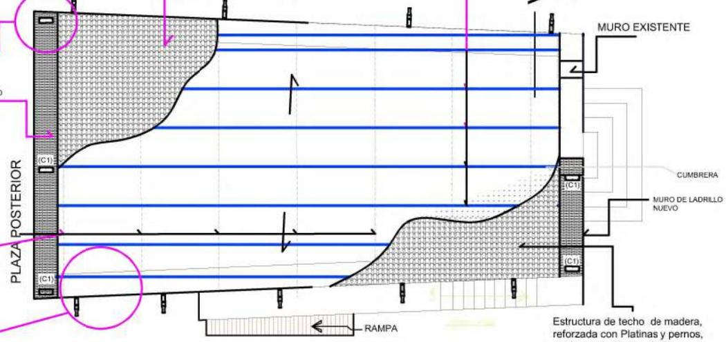
Estructura de techo de madera, reforzada con Platinas y pernos, cubiertas de lámina de fibro cemento, con hiladas alternas, de teja de barro. Ver detalle 2
