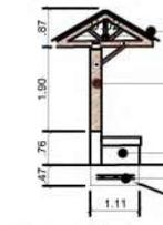
BANCA DE CONCRETO CIMENTO DE CONCRETO
