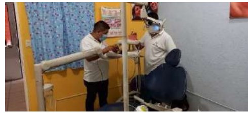
Imagen 2.6 de Mario García (Malacatán, San Marcos 2023). Archivos de Ejercicio Profesional Supervisado en Malacatán, San Marcos. Nota: Mantenimiento de unidad para corregir la irrigación de pieza de alta velocidad.
