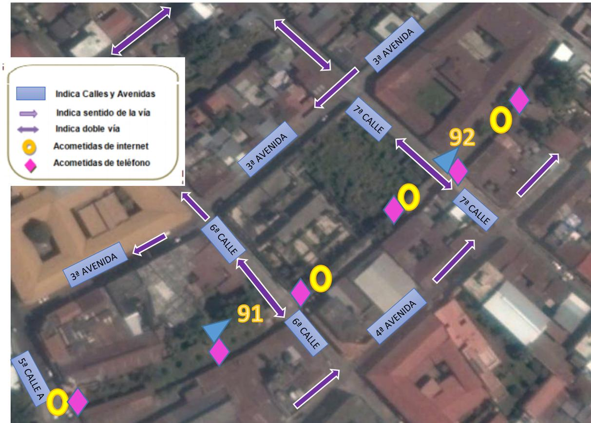
**Figura 90.** Análisis de sentido de la vía y acometidas existentes. 2018. Fuente: Elaboración propia.
