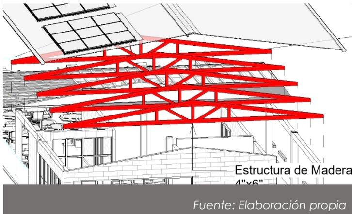
En el área del restaurante se colocará una estructura portante para la cubierta, de vigas de madera con dimensiones de 4"x6", los cuales se anclarán por medio de una porta vigas en sus extremos.
