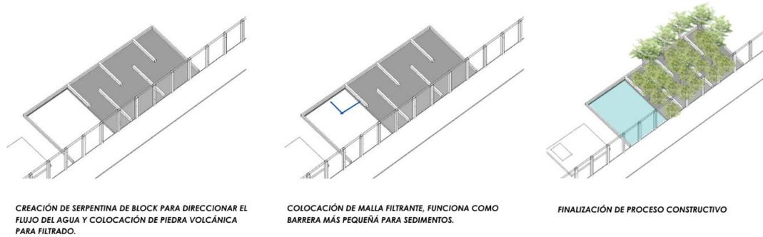
**Ilustración 75 Esquema del proceso de construcción de Humedal Artificial.**
