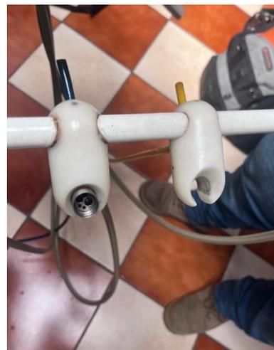
Jeringa triple quebrada, la tubería de aire se compartía con la tubería de agua, filtración de agua todo el tiempo, manguera de pieza de baja velocidad en malas condiciones.
