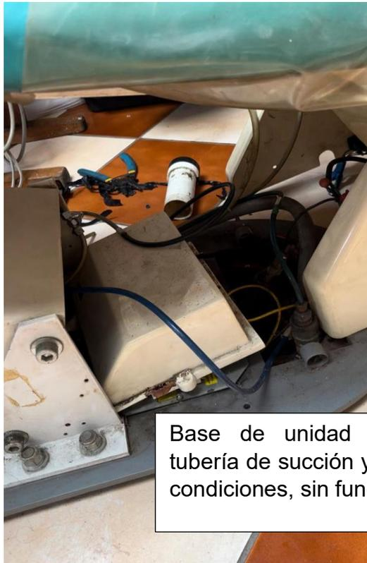
Base de unidad dental quebrada, tubería de succión y drenaje en malas condiciones, sin función.
