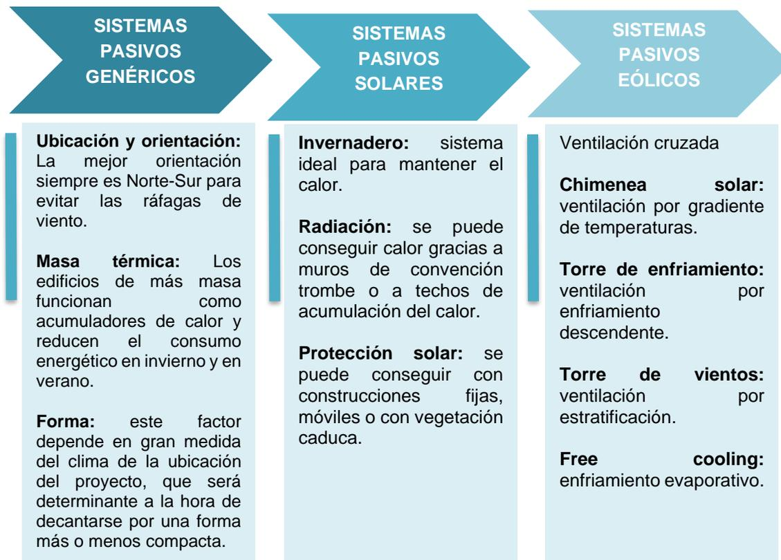
Figura 9. Esquema de los Tipos de sistemas pasivos. Fuente: Elaboración propia basada en el documento web: "Construcción eficiente: Sistemas pasivos con realiza".
