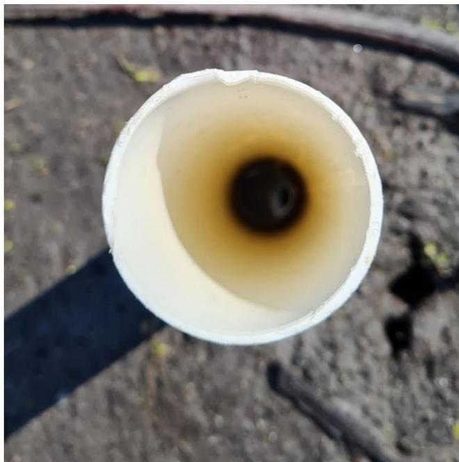
**Figura 22** Piezómetro para tomar muestra del agua intersticial.
