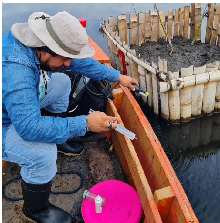
**Figura 25** Calibración de sonda multiparamétrica.
