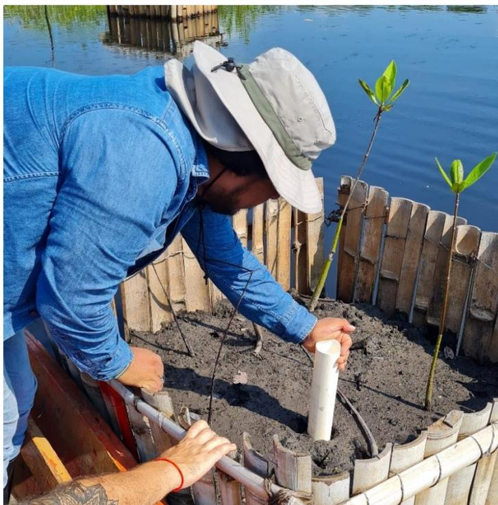
**Figura 21** Colocación de piezómetro para medir datos fisicoquímicos del agua intersticial.
