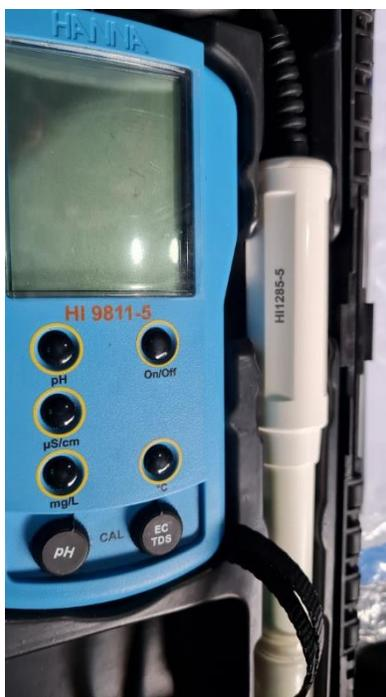
**Figura 17** Sonda multiparamétrica Hanna, modelo HI 9811-5.
