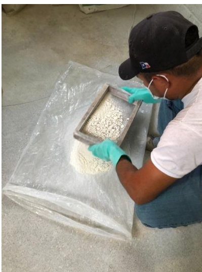
Figura 25. Preparación de mezcla de A.N.A. con talco.
