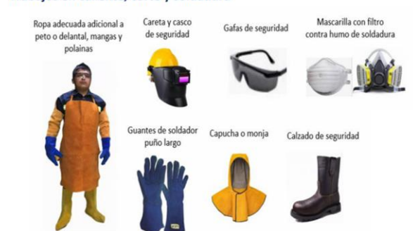
Trabajos en caliente, corte y soldadura
