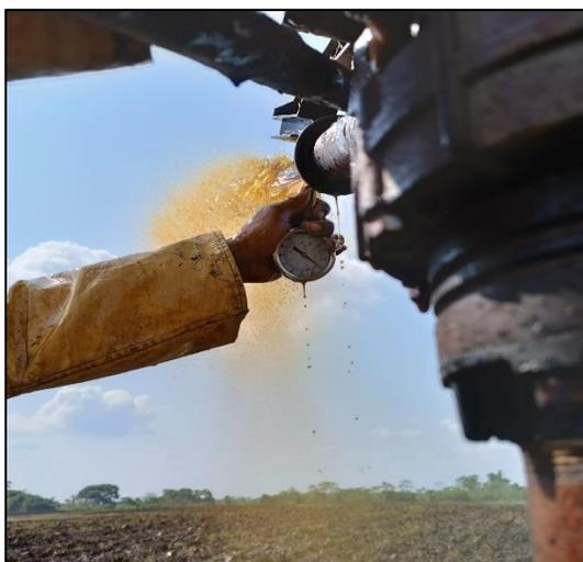
**Figura 9. Presión de salida del aspersor utilizando un manómetro de glicerina con tubo Pitot.**
