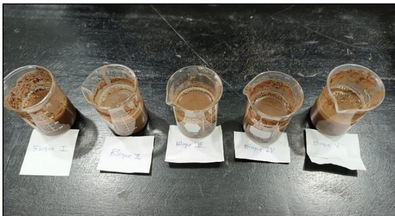
**Figura 13. Soluciones agua suelo preparadas para la determinación del pH y conductividad eléctrica.**
