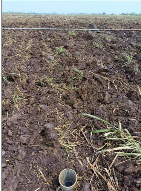
**Figura 10. Colocación de los pluviómetros en el área de mojado del aspersor.**
