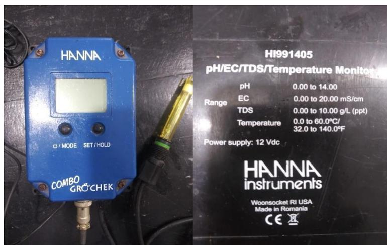
**Figura 12. Potenciómetro y conductímetro marca Hanna, modelo HI991405 utilizado para las mediciones de pH y CE.**
