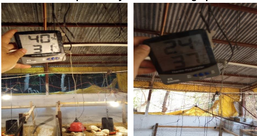
Figura 35Ap. Determinación de temperatura con termo hidrómetro para medición de temperatura y humedad del galpón
