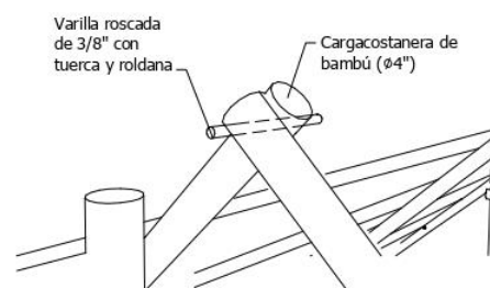
14. Detalles de Cargacostaneras en la Cumbre.
