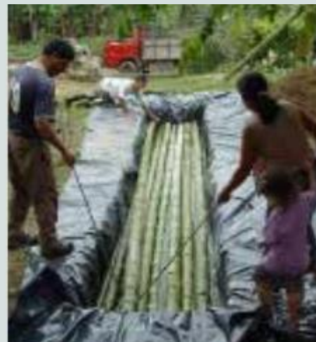
Figura 39 Preservación tradicional, (INBAR 2015) Fuente: Construir con Bambú (Caña de Guayaquil)
