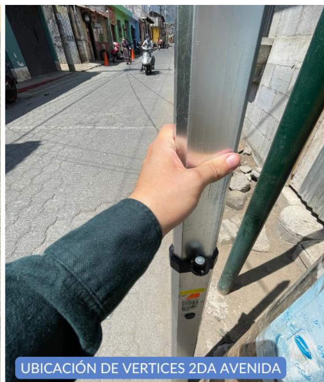
Figura 78. A la izquierda fotografía de ubicación de postes de energía eléctrica y a la derecha colocación de Estatal nivelado para determinar los vértices de la Segunda Avenida de San Antonio Aguas Calientes, 2021.
