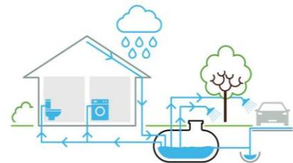
Figura 62. Esquema captación pluvial.
