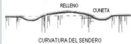
Figura 70. Esquema curvatura de terreno en senderos.
