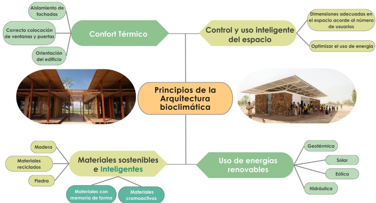
Figura 21: Principios de la arquitectura bioclimática.
