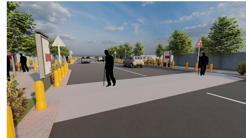
VISTA DEL ELEMENTO HORIZONTAL PARA DISMINUCIÓN DE VELOCIDAD DE LOS VEHÍCULOS, FRENTE AL INGRESO PEATONAL AL EDIFICIO
