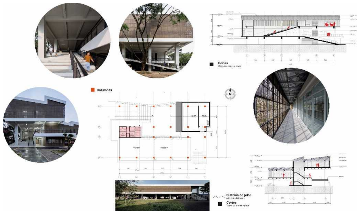
Figura 50. Análisis de estructura. Centro Creativo y de Innovación Tasik.
