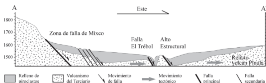
Figura No. 70. Sección transversal mapa de fracturas provocada por el terremoto de 1976.
