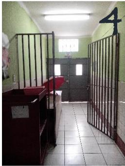
**Ilustración 26** Salida de emergencia, obstaculizada, elaboración propia.
