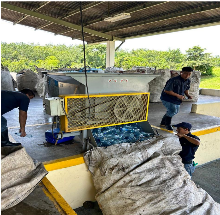
Figura 27 Proceso de compresión de botellas plásticas.
