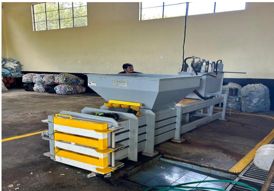
Figura 67 Máquina compactadora para desechos inorgánicos no recuperables.
