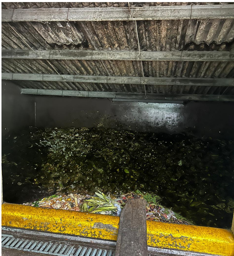
Figura 12 Fase de encierro en las cámaras de compostaje.
