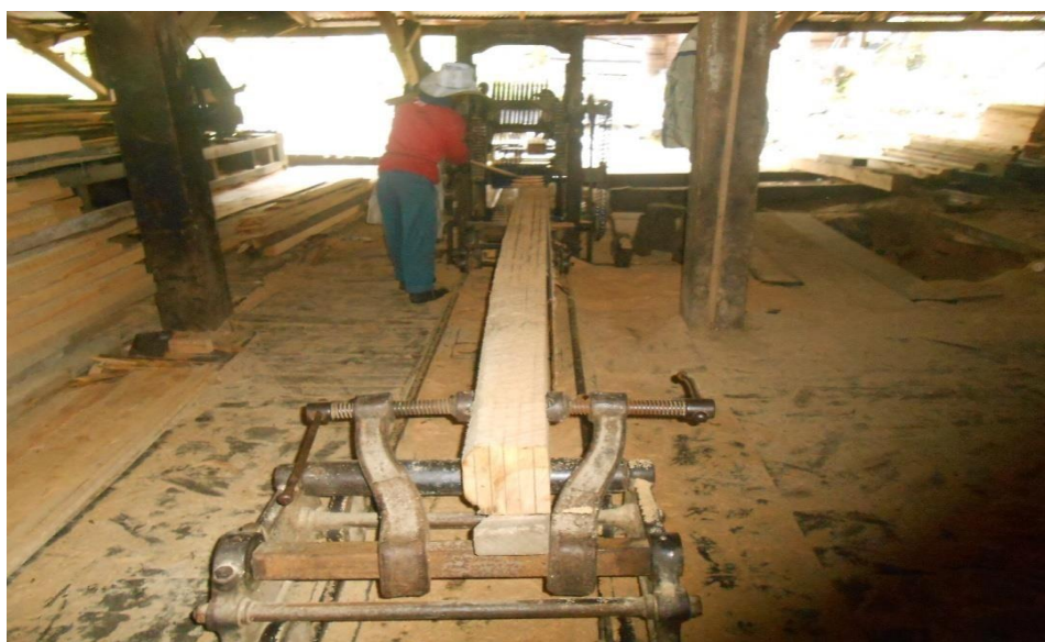
Figura 9. Trabajo con sierra circular. Piezas aserradas de ciprés común. Fuente. Luis Aguilar, año 2024
