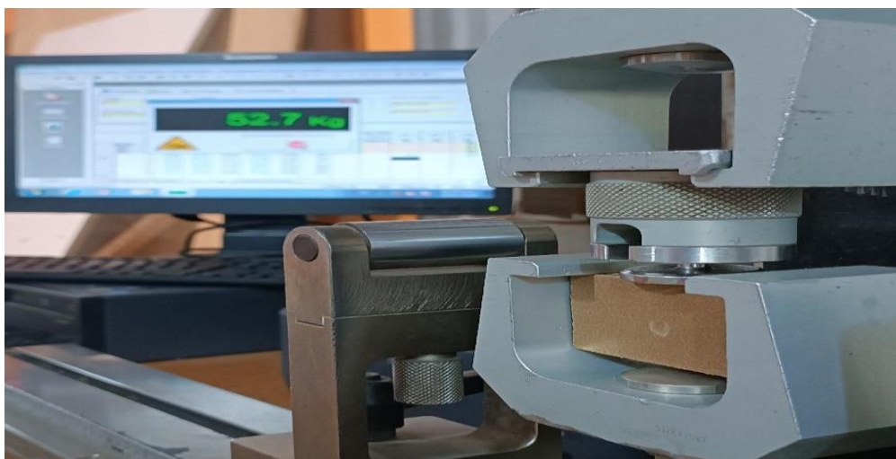
Figura 9. Pruebas destructivas de extracción de tornillo
