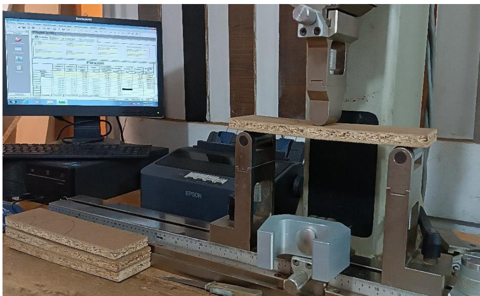
Figura 8. Pruebas destructivas de Flexión
