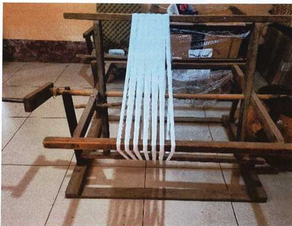
Figura 15: Madejadera de madera para elaborar una tendida de labor.
