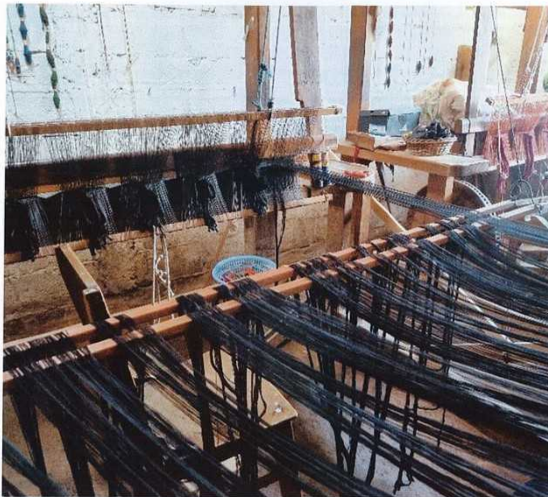
Figura 14: Procedimiento de betillado donde se pasa hebra por hebra en la aviadura.
