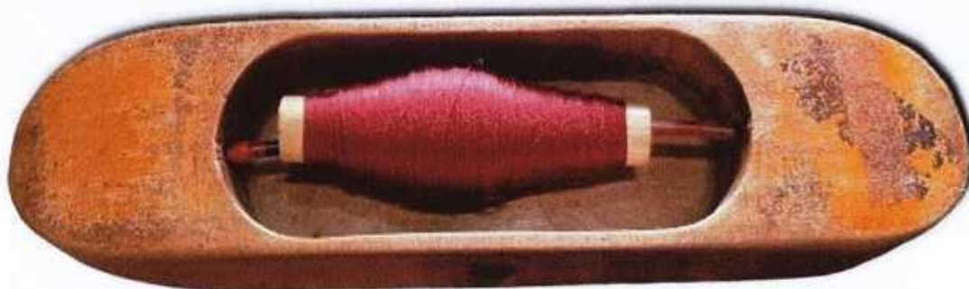
Figura 44: Lanzadera de madera para canillas de colores con una medida de 10 centímetros de largo por 3 de ancho que se utiliza para tejer en el telar de pie.
