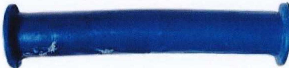
Figura 42: Vacia de plástico color azul de 5 centímetros de largo por un centímetro de diámetro.
