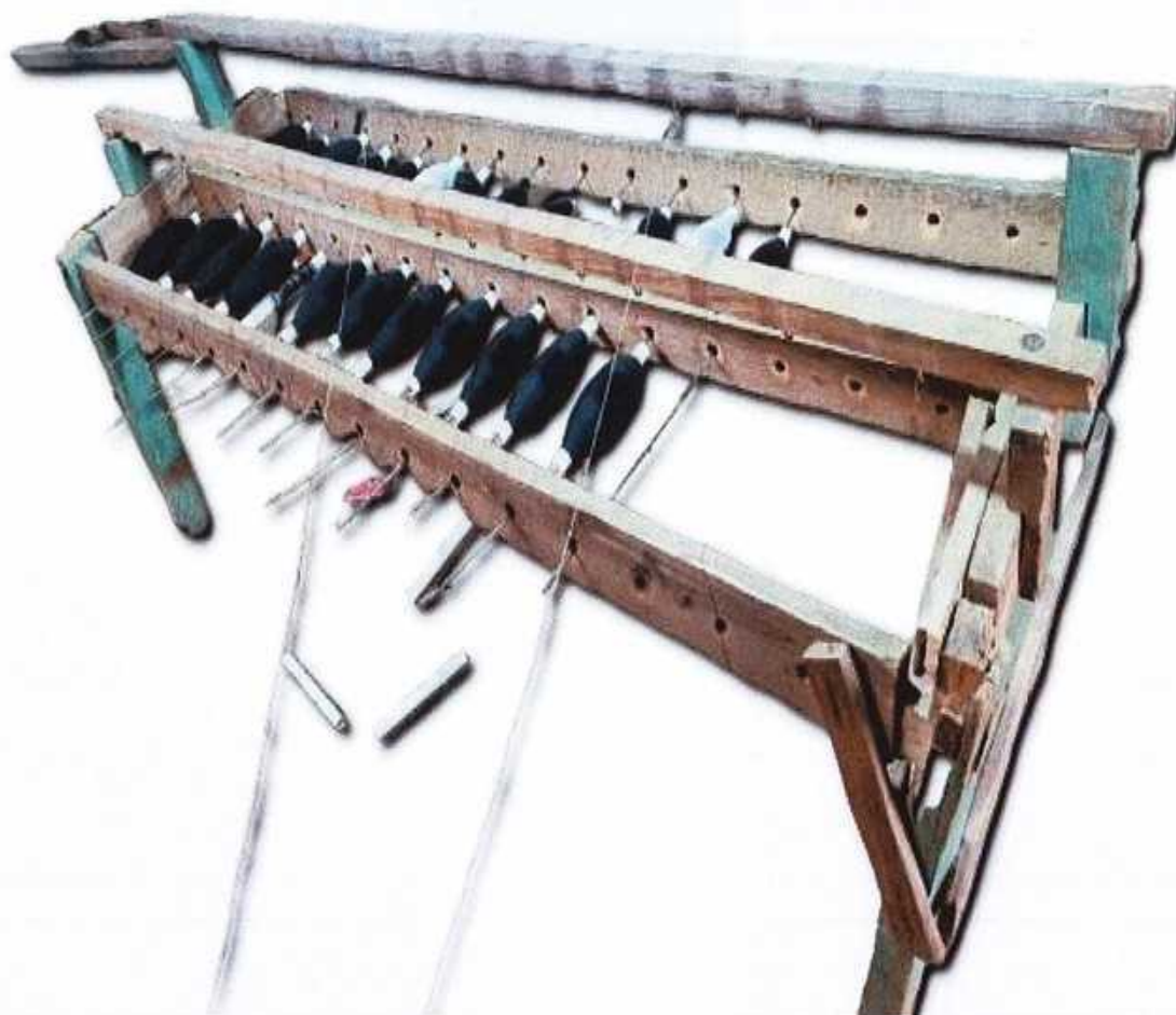
Figura 12: Fotografía de una trascañonera elaborado de madera que mide aproximadamente 2 metros de largo por medio metro de altura y se utiliza para separar las hebras de hilo de los cañones para preparar una tela.
