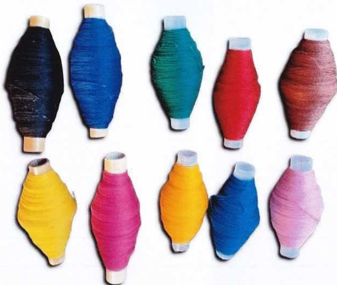
Figura 21: Canillas con 10 colores diferentes de hilo de la marca el Rendidor Mish. Herramientas de trabajo que se utilizan de forma conjunta con una lanzadera para elaborar los tejidos en el telar de pie.
