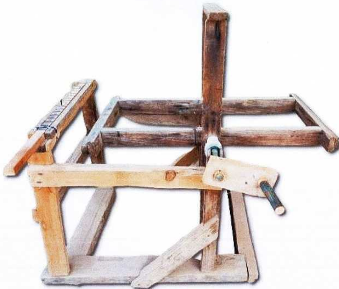
Figura 28: Urdidor de madera de 1 metro de largo por \frac{1}{2} metro de ancho aproximadamente para urdir madejas de labores.
