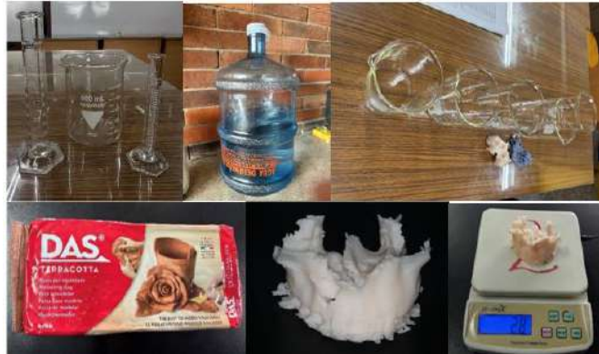
Imagen 4. Materiales utilizados para la medición de las variables: Becker de vidrio de 500ml, agua desmineralizada (más inocuo), Jeringa 50ml calibrada de milímetro en milímetro, arcilla roja, modelos de estudio y balanza digital.
