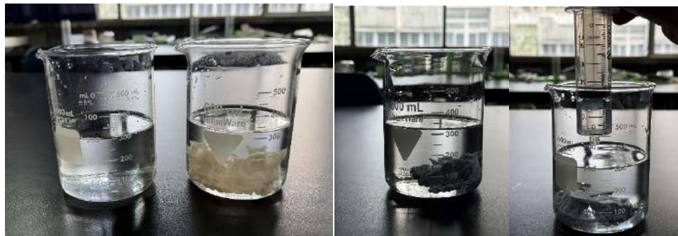
Imagen 5. Prueba de desplazamiento de agua
