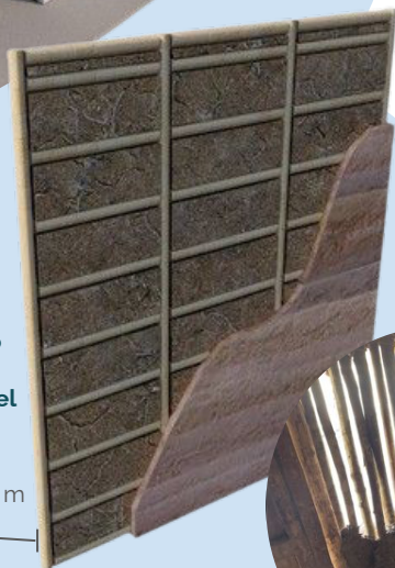
Muros tapiales + gaviones de piedra encofrada en rejillas metálicas primer nivel
