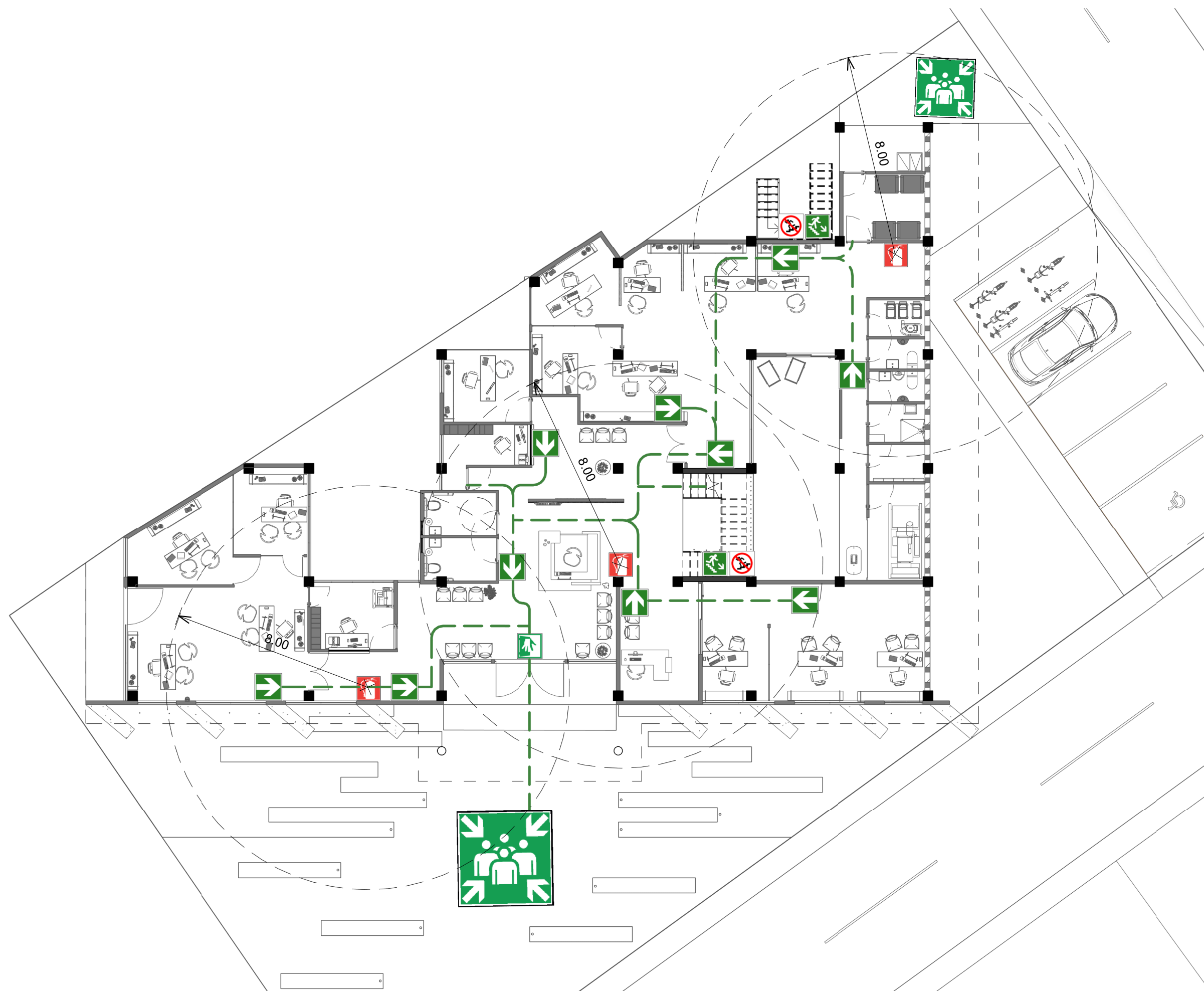
1 PLANTA BAJA DE SALIDAS DE EMERGENCIA ESC. 1 : 150
