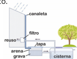
Figura 12. Captación de agua de lluvia
