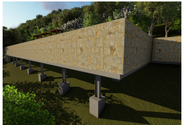
Figura 118. Vista de pedestal del sistema estructural. (Elaboración propia, 2025)
