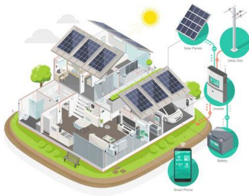
FIGURA 101 ESQUEMA DE SISTEMA DE PANELES SOLARES FUENTE: SYSCOM ING CARLOS CHAPARRO, “ HTTPS://WWW.SYSCOMBLOG.COM/2022/12/SE-IMAGINA-TENER-EL-CONTROL-DE-SUS_30.HTML “VISITADO 18 DE AGO. DE 25
