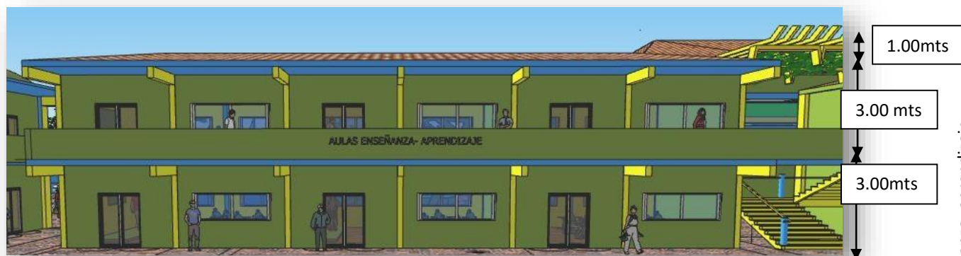
ELEVACIÓN PERSPECTIVADA AULAS
