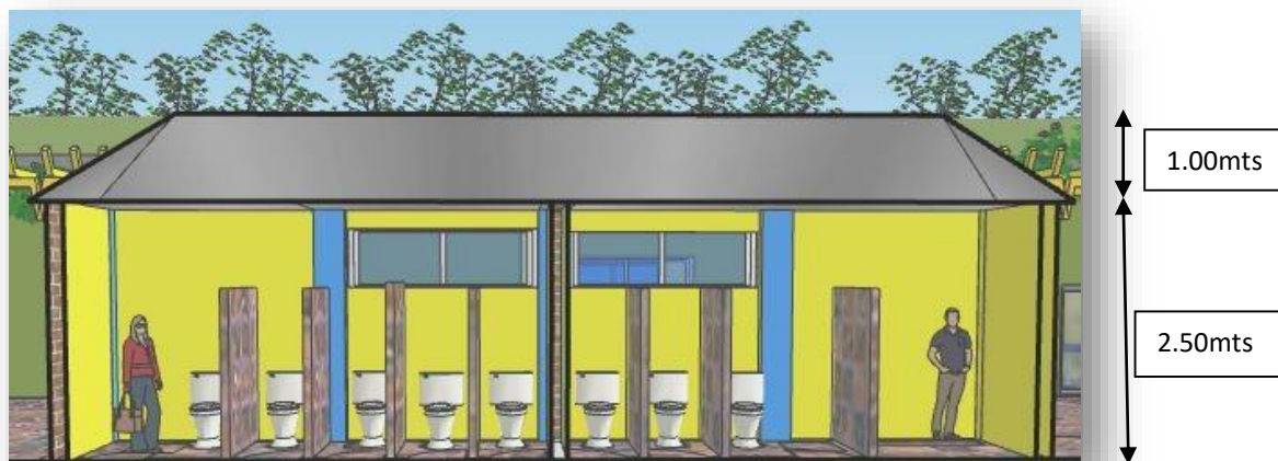
SECCIÓN PERSPECTIVADA SERVICIOS SANITARIOS
