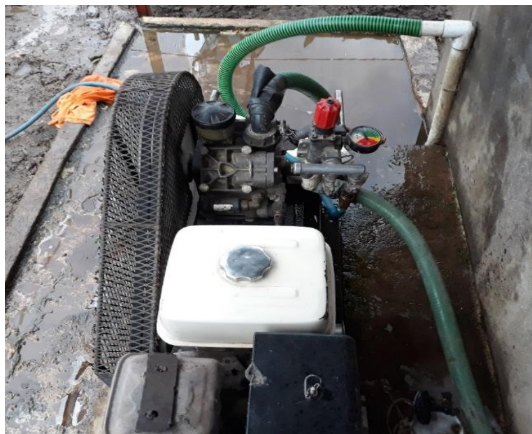
Figura 45. Motor de 6.5 Hp utilizado para la distribución del producto Fuente. Propia EPS 2019
