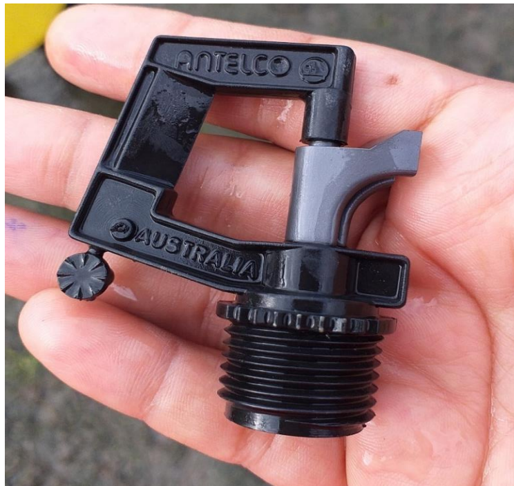
Figura 10. Micro aspersor Rotor rine utilizado en el riego de Leather leaf. Fuente: propia EPS 2019
