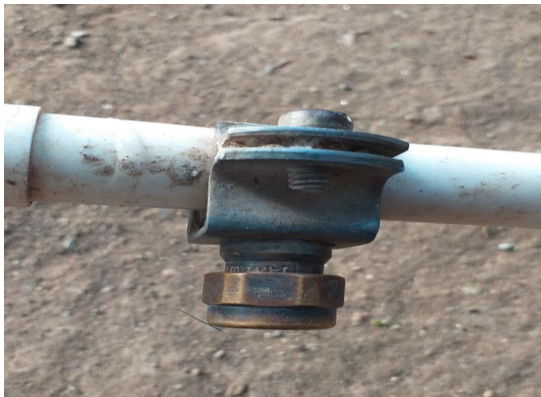
Figura 48. Agarre de la boquilla de distribución. Fuente. Propia EPS 2019
