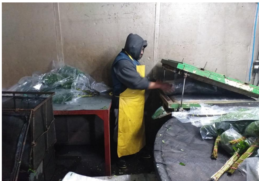
Figura 83. Procedimiento para sellado al vacío en el cuarto frío. Fuente. Propia EPS 2019
