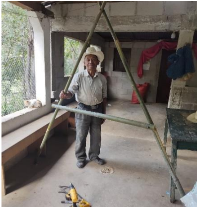
Figura 51 “A” Elaboración de nivel tipo A.
